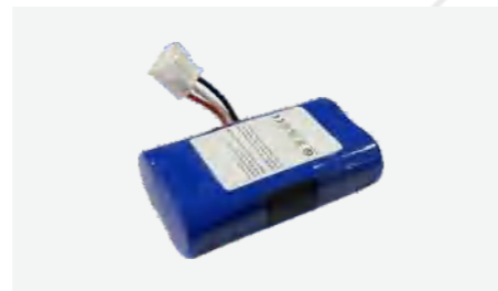
金融POS終端圆柱形リチウム電池組 組立方式: 2S1P 容量: 2600mAh 充電温度: 0°C~+45°C 放電温度: -20°C~+60°C
